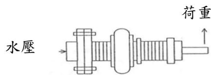
圖 8 彎曲試驗設備圖示範例
