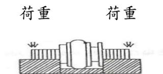
圖 9 壓壞試驗設備圖示範例
